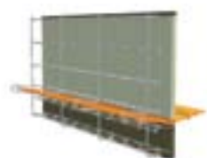
Fuga di dilatazione con waterstop
