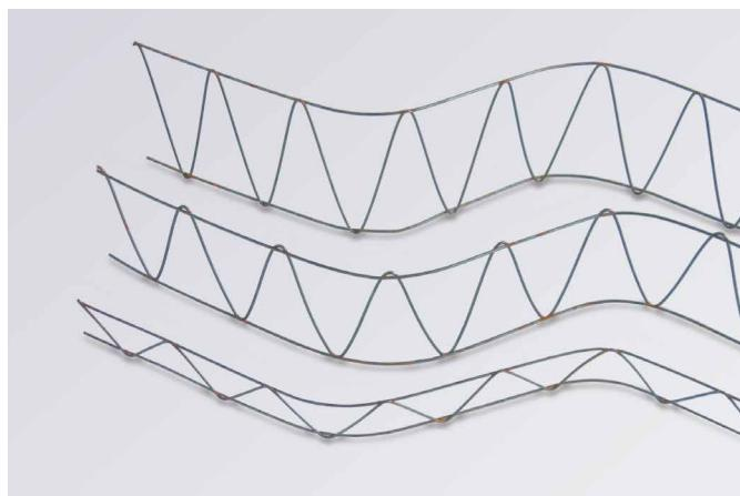
Diese Distanzstreifen liegen zwischen der oberen und unteren Bewehrung von Platten, sowie zwischen äußerer und innerer Bewehrung von Wänden. Sie stehen nicht auf der Schalung (keine Kunststoff-Füßchen) und ergeben daher einen einwandfreien Sichbeton.
